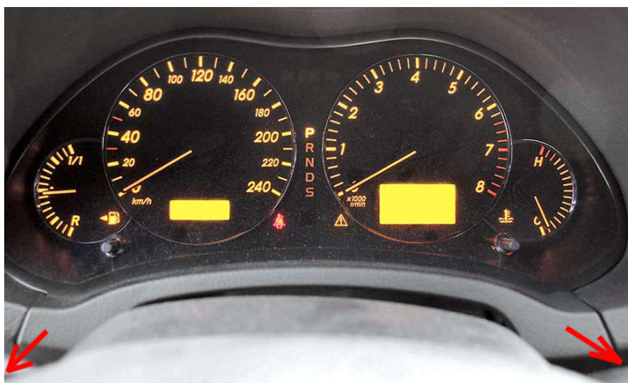
Рис.3. Снятие накладки панели приборов
