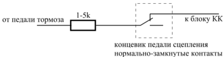
Рис.9. подключение в случае механической КПП
