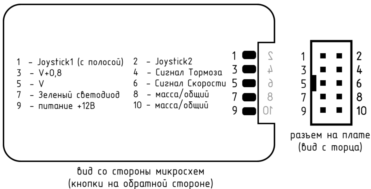
Рис.2. Схема выводов платы КК
