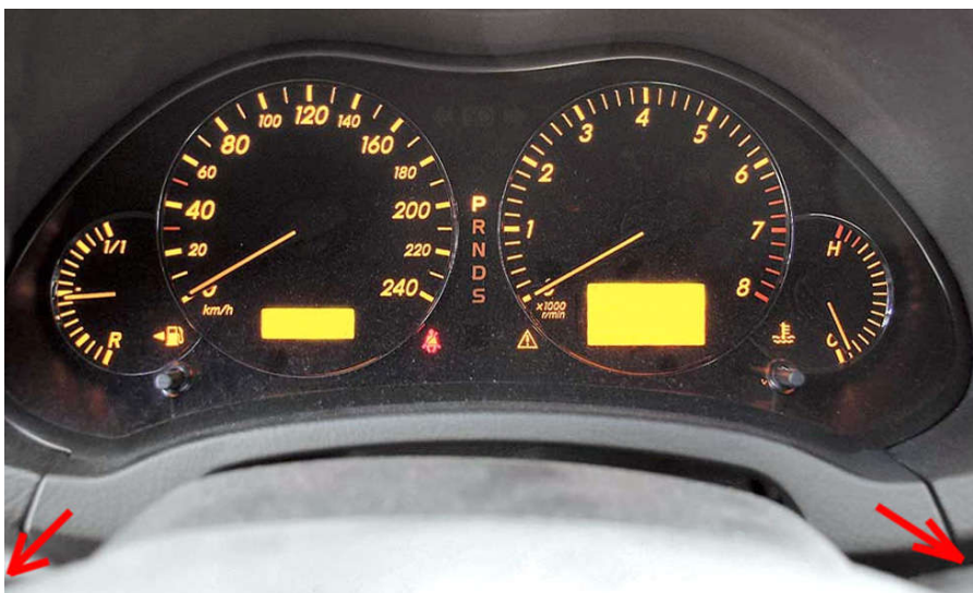
Рис.3. Снятие накладки панели приборов
