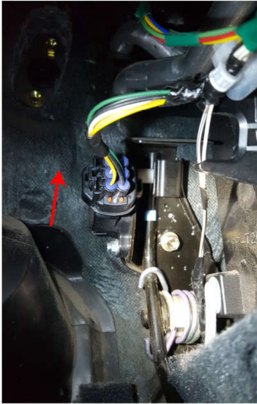
Рис.6. Отсоединение проводов педали газа
